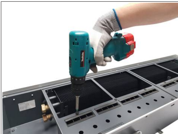
Ill. : 8: Desserrer les vis de l'habillage
