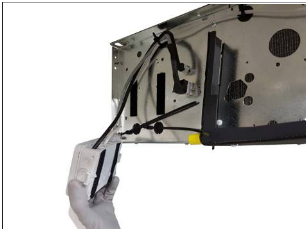
Ill. : 43: Retirer la prise de courant de la bande auto-agrippante
